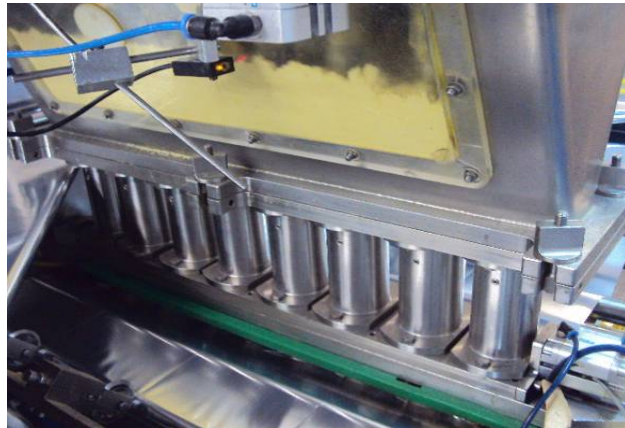
Figura 16. Vista exterior de tolva y tornillos
