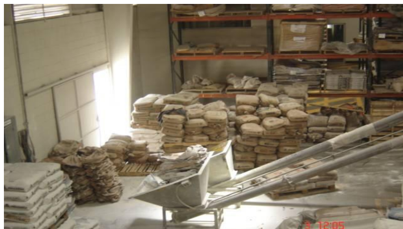
Figura 34. Obstrucción de salida de emergencia de BPT
