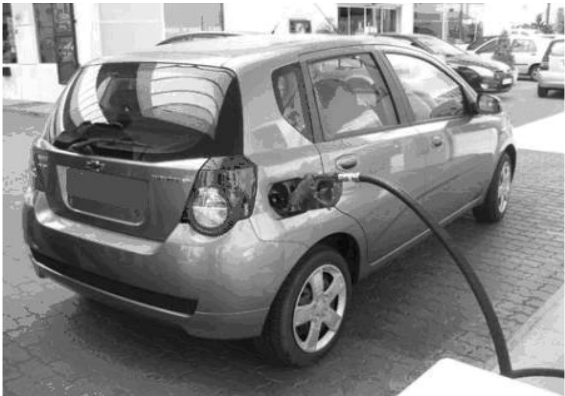
Figura 45. Abastecimiento de un vehículo con sistema GLP
