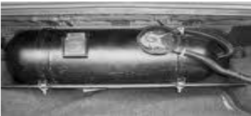
Figura 30. Tanque de almacenamiento de GLP para vehículos
