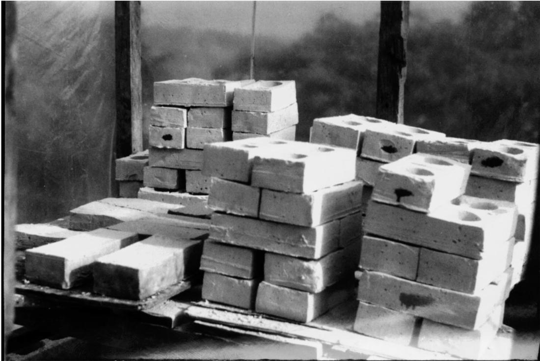
Ladrillos al tercer día de secado, se observa que ya pueden manipularse y apilarse.
