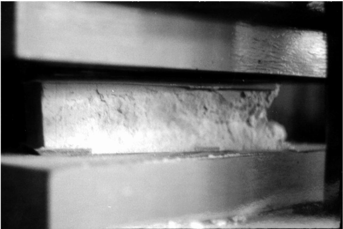
Momento en que se aplica la carga a compresión sobre el ladrillo, y se empieza a observar la falla del mismo.
