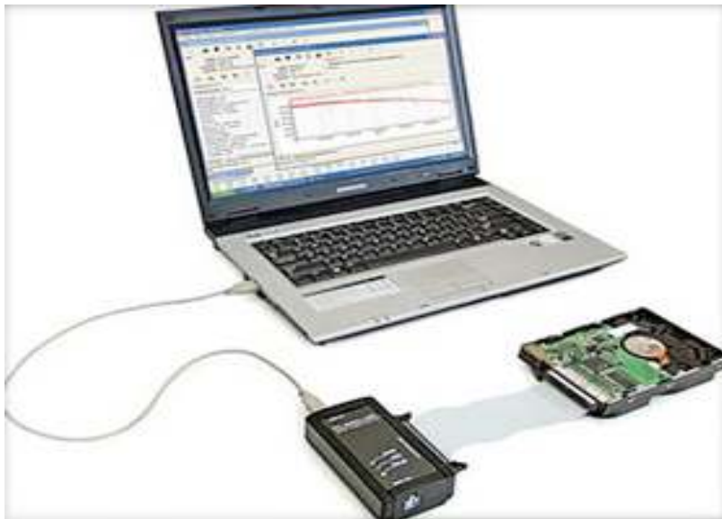
Figura 12. Conexión disco duro-bloqueador-computadora forense
