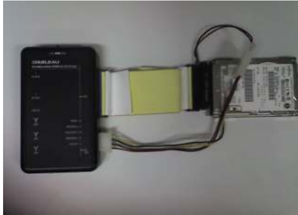
Figura 11. Conexión disco duro a bloqueador
