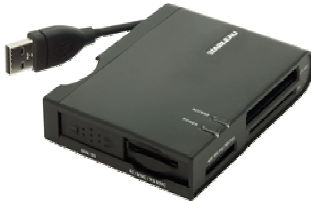
Figura 5. Multi-lector y bloqueador de tarjetas
