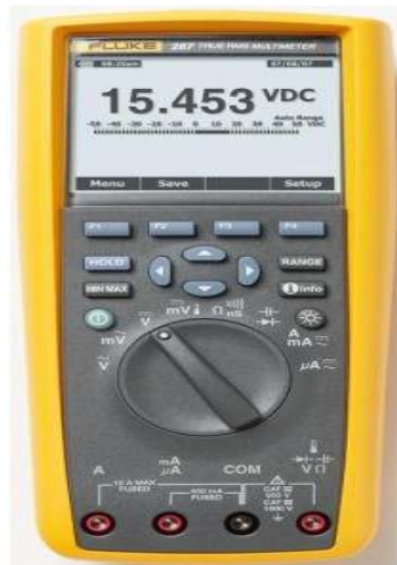
Figura 25. Ejemplo de tester digital ( FLUKE 287 )
