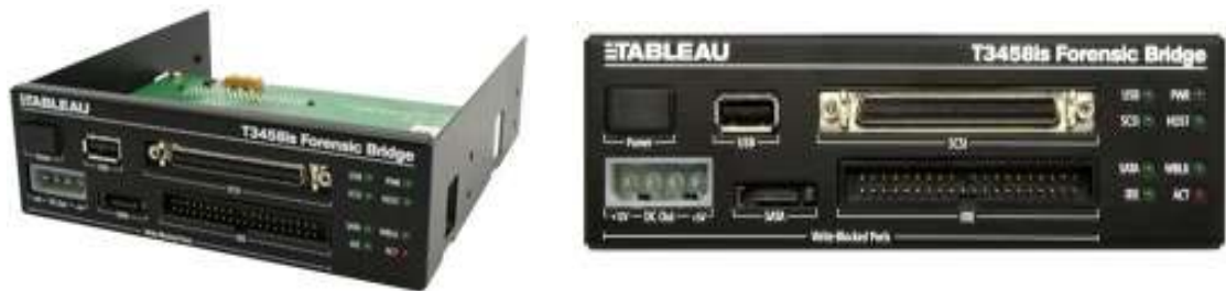
Figura 6. Lector y bloqueador de tarjetas conexiones USB/SATA/SCSI/IDE
