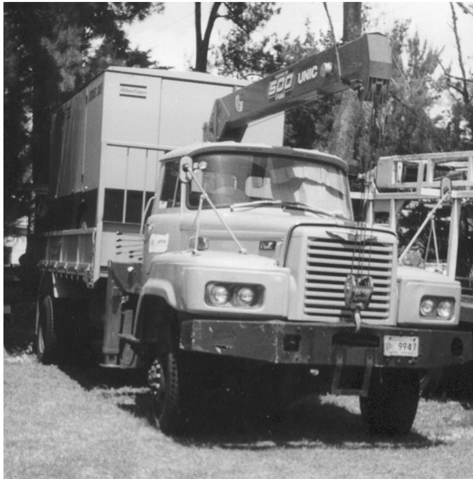
Figura 13. Camión para transportar equipo de bombeo hacia el lugar de trabajo
