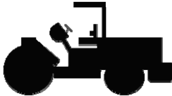
Figura 14. Rodo vibratorio de tambores lisos tipo tándem para acomodamiento del concreto y vibrado de la mezcla
