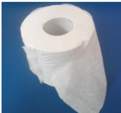
Imagen 7 Rollo con fallas de laminación
