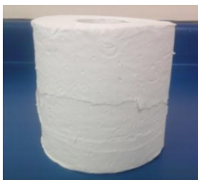
Imagen 8 Rollo con rasgaduras
