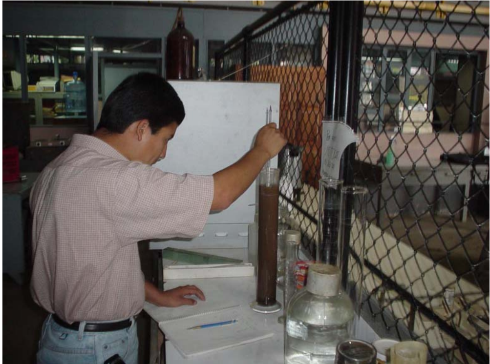
Figura 10. Granulometría “Método del Hidrómetro” en el laboratorio de Mecánica de Suelos del Centro de Investigaciones de Ingeniería.
