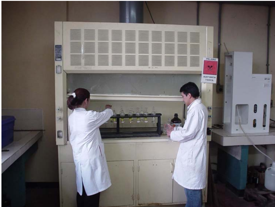
Figura 8. Ataque de ácidos a las muestras en el laboratorio del Ministerio de Energía y Minas
