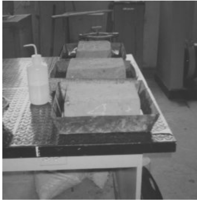
Figura 4. Adobes en proceso de absorción
