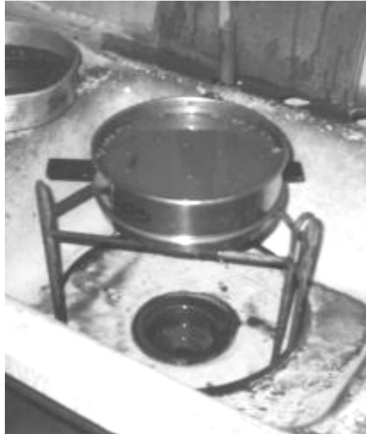
Figura 12. Material fino pasando por tamiz # 200, vía húmeda
