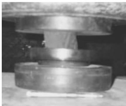
Figura 7. Cubo de mortero ensayado a los 7 días
