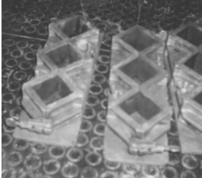
Figura 5. Moldes utilizados para ensayo de compresión de mortero
