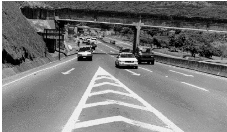
Figura 9. Rampa de salida directa
