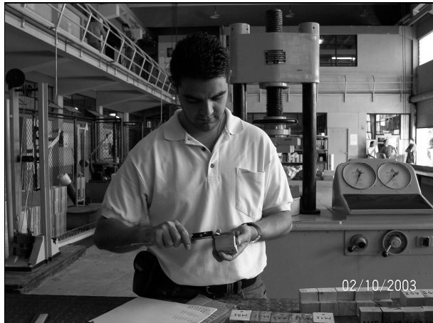
Figura 29. Medición de las probetas para ensayo a corte
