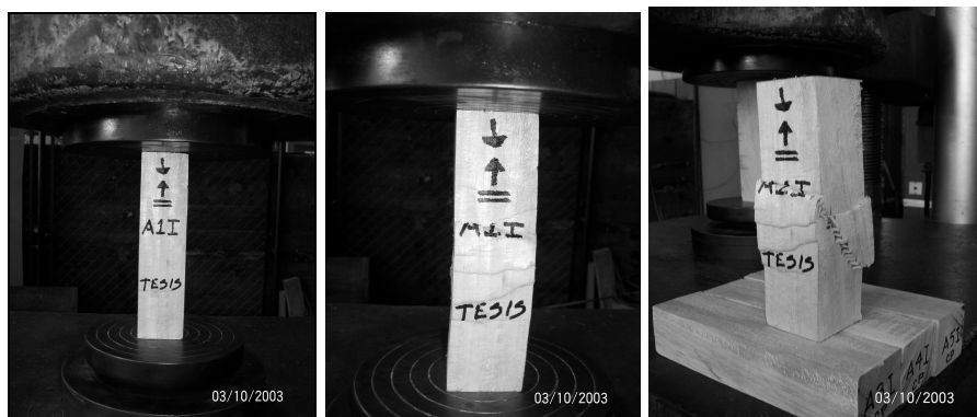
Figura 25. Proceso del ensayo de compresión paralela
