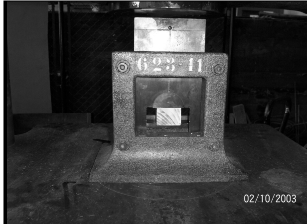
Figura 30. Ensayo a corte vista frontal
