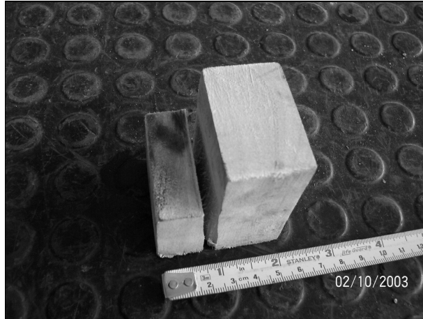
Figura 32. Probeta después del ensayo a corte paralelo.
