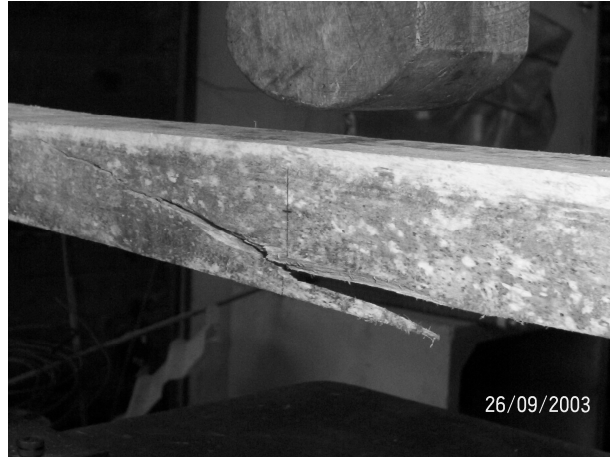
Figura 20 . Después del ensayo a flexión
