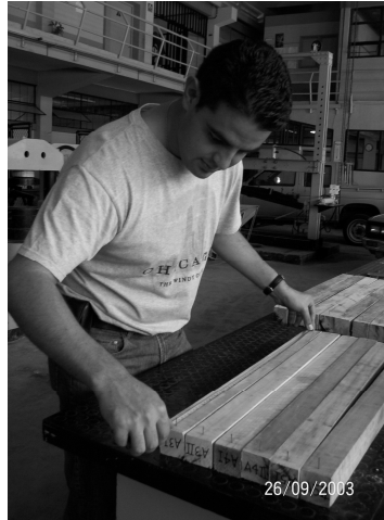
Figura 16. Medición de probetas previo a ensayos por flexión
