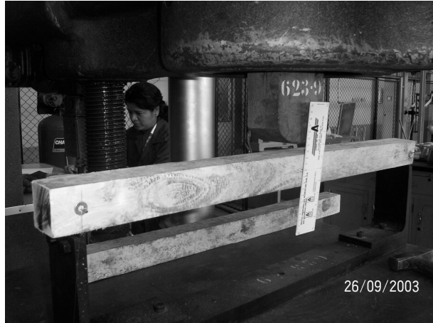
Figura 18. Antes del ensayo a flexión
