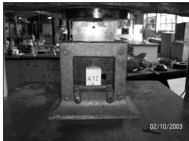
Figura 31. Ensayo a corte vista posterior
