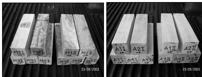
Figura 24. Probetas antes del ensayo de compresión paralela
