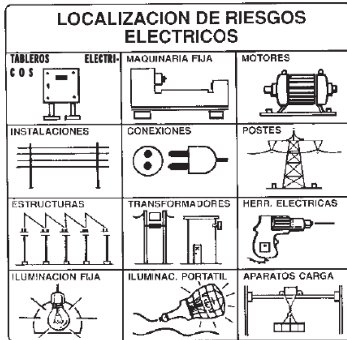
Figura 5. Localización de riesgos eléctricos
