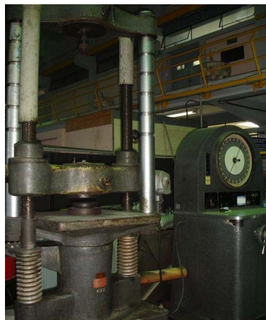
Figura 17. Máquina Universal, edificio T-5
