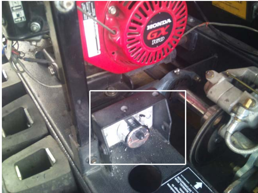
Figura 29. Contador de circuitos implementado al go kart
