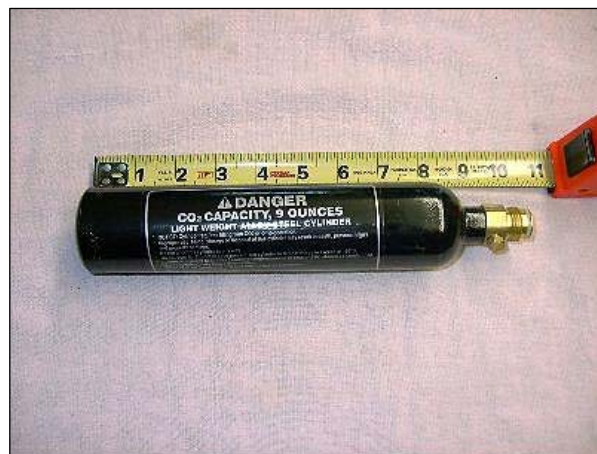
Figura 9. Tanque de nueve onzas de dióxido de carbono
