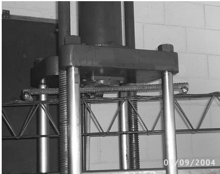
Figura 101 Ensayo a flexión en costanera EVG6
