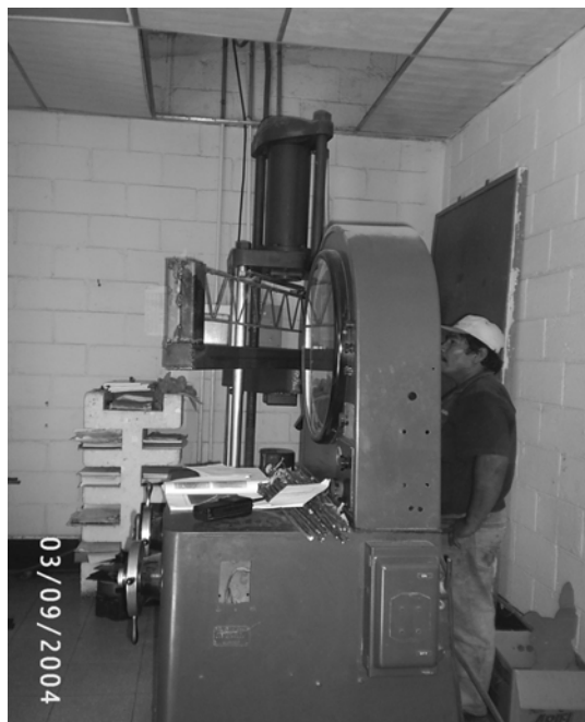
Figura 79 Medición de deflexiones durante el ensayo
