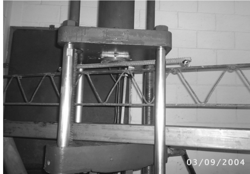
Figura 79 Medición de deflexiones durante el ensayo
