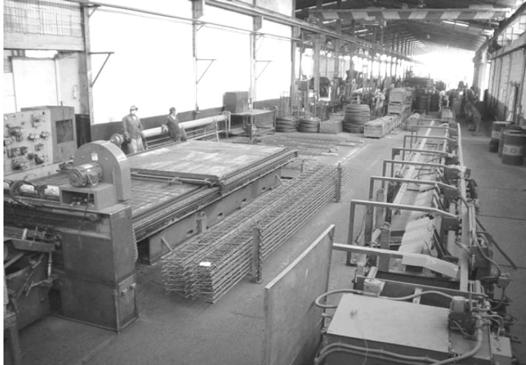
Figura 14 Proceso de fabricación del joist Filigran
