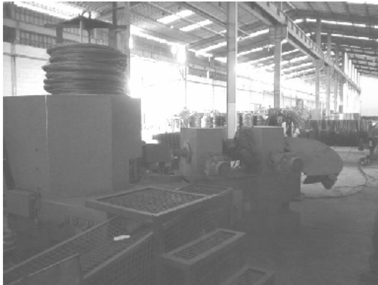
Figura 25 Alambión trefilado previo a ser insertado en la máquina EVG
