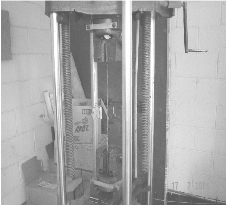
Figura 56 Ensayo a tensión en materia prima para costanera EVG
