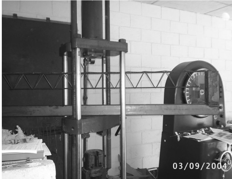
Figura 101 Ensayo a flexión en costanera EVG6
