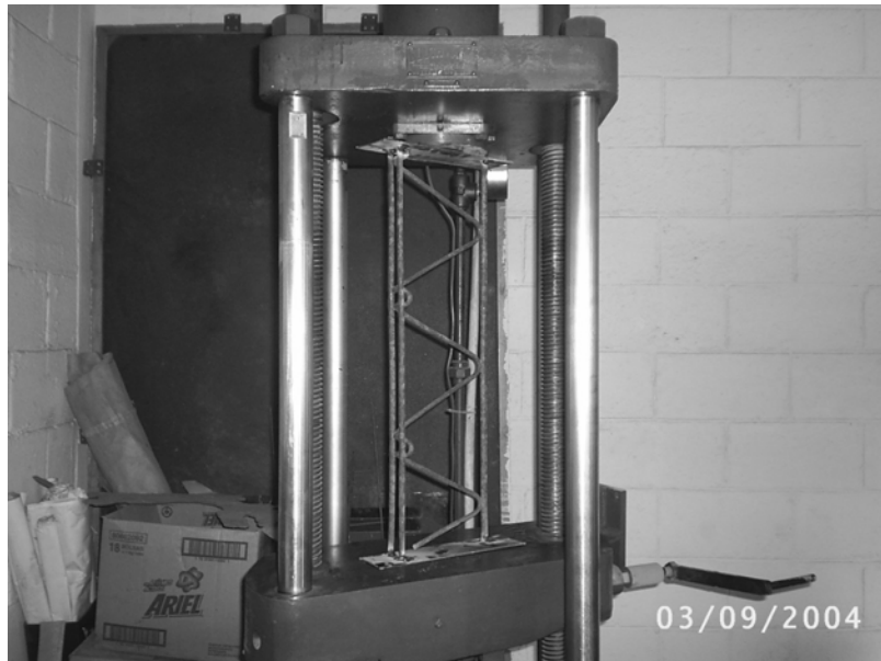
Figura 73 Ensayo a compresión en joist Filigran
