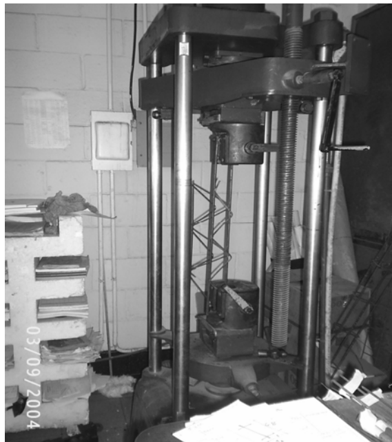
Figura 90 Cordón de costanera EVG después de ser ensayado
