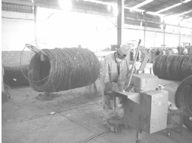
Figura 22 Enhebrado del alambrión previo a ser trefilado
