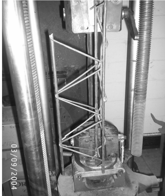
Figura 89 Ensayo a tensión en cordón simple de costanera EVG
