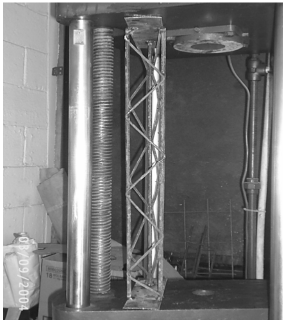
Figura 97 Costaneras EVG4 y EVG6 después de ser ensayadas
