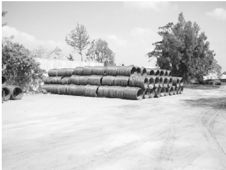
Figura 21 Alambrón utilizado en la fabricación de la costanera EVG
