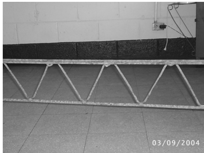
Figura 15 Joist Filigran terminado
