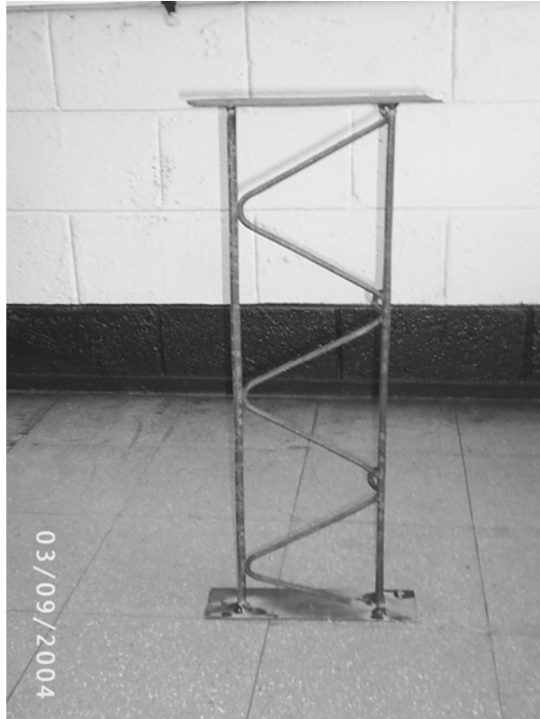
Figura 72 Ensayo a compresión en joist Filigran
