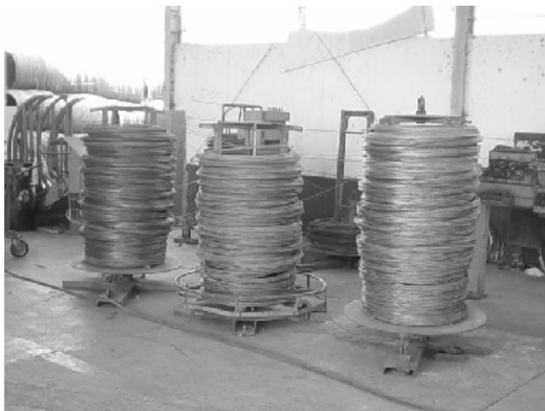
Figura 25 Alambión trefilado previo a ser insertado en la máquina EVG
