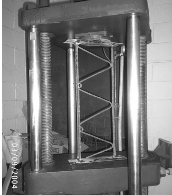
Figura 73 Ensayo a compresión en joist Filigran
