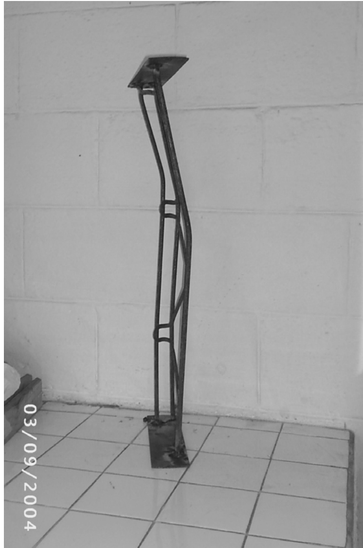
Figura 74 Joist Filigran después de ser ensayado
