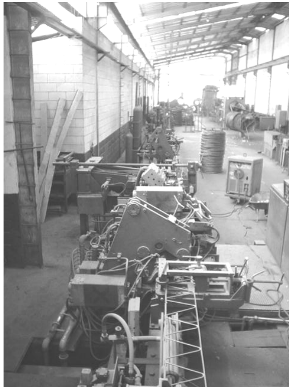
Figura 13 Proceso de fabricación del joist Filigran
