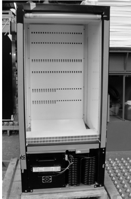
Figura 15. Equipo con unidad Deck instalada
