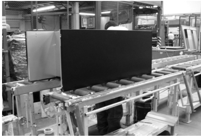
Figura 8. Ensamble de gabinete
