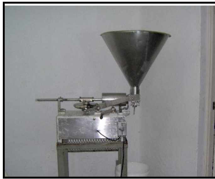
Figura 11. Envasadora semiautomática para productos viscosos de Shalom, S. A.
