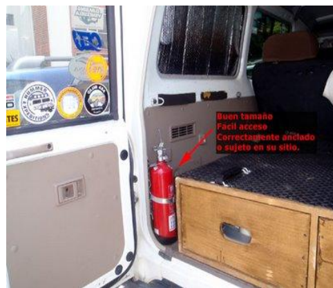
Figura 24. Lugar adecuado para un extintor dentro de un vehículo
