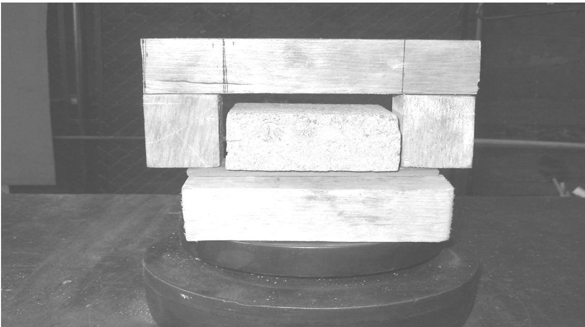
Figura 3. Elementos de transmisión de fuerzas fabricados en madera
