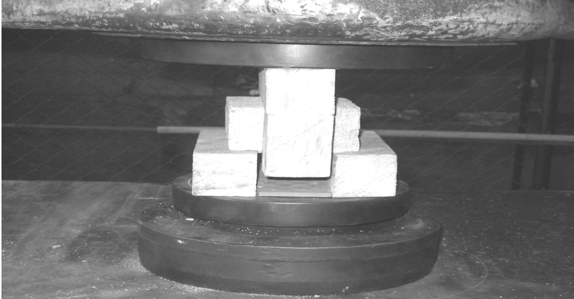
Figura 2. Elementos de transmisión de fuerzas y probeta para ensayo
