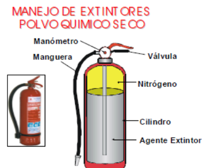
Figura 122. Partes de un extintor
