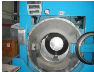
Figura 42. Cámara de lavadora industrial
