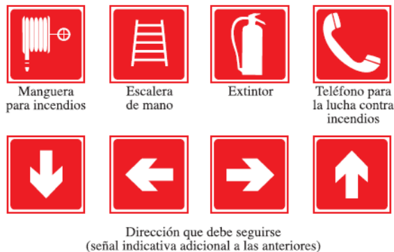
Figura 114. Señales de equipo contra incendio
