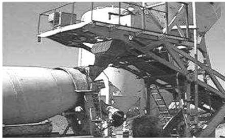
Foto - Dosificación de los agregados en planta
