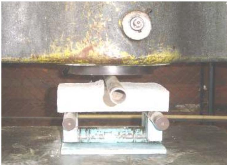
**Figura 13. Probeta al momento de la falla producida por flexión**
