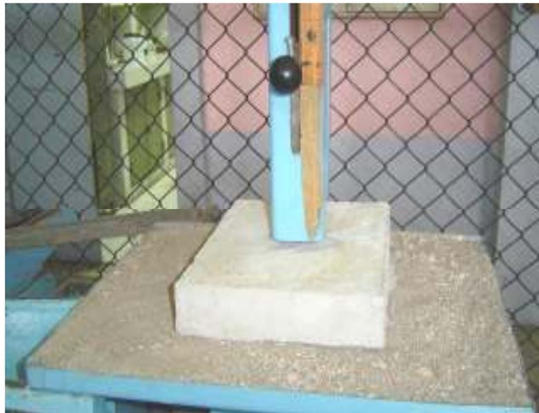
**Figura 15. Probeta al momento de la falla producida por el impacto**
