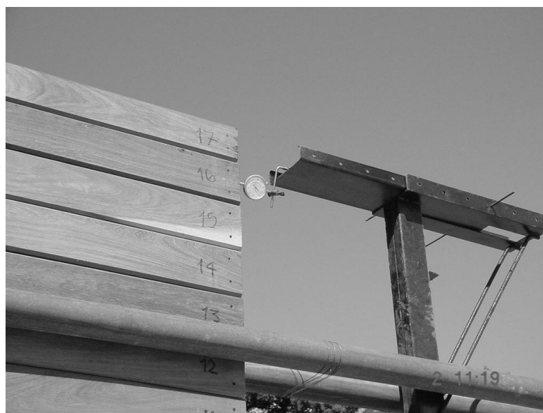
b) Deformómetro para chequear ladeo
