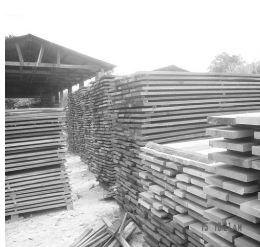
Figura 23. Apilado y secado
