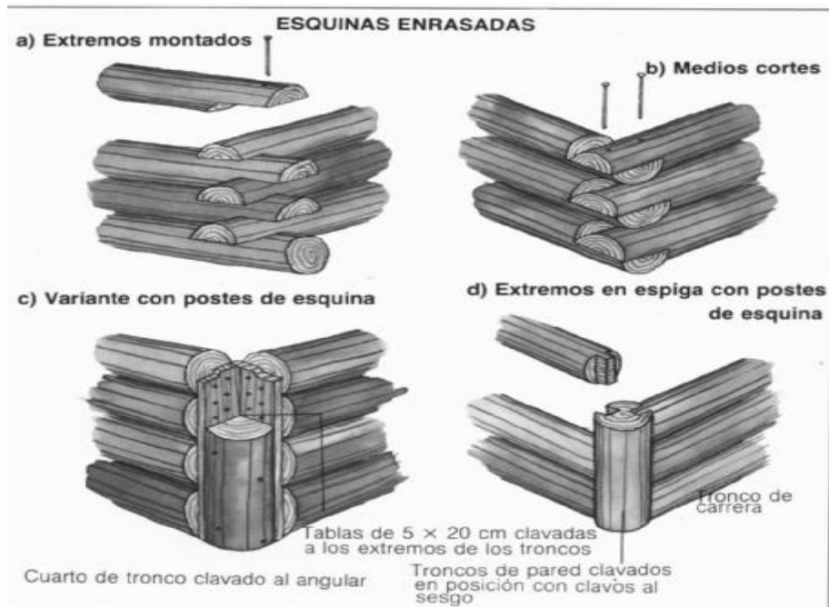
Figura 4. Ensambladuras de esquinas enrasadas
