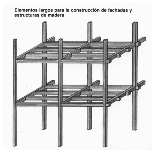
Figura 8. Entramado de elementos largos
