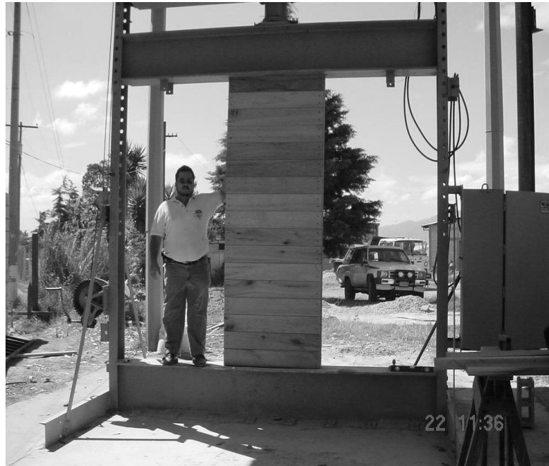
Figura 34. Colocación de pared a compresión en marco de carga
