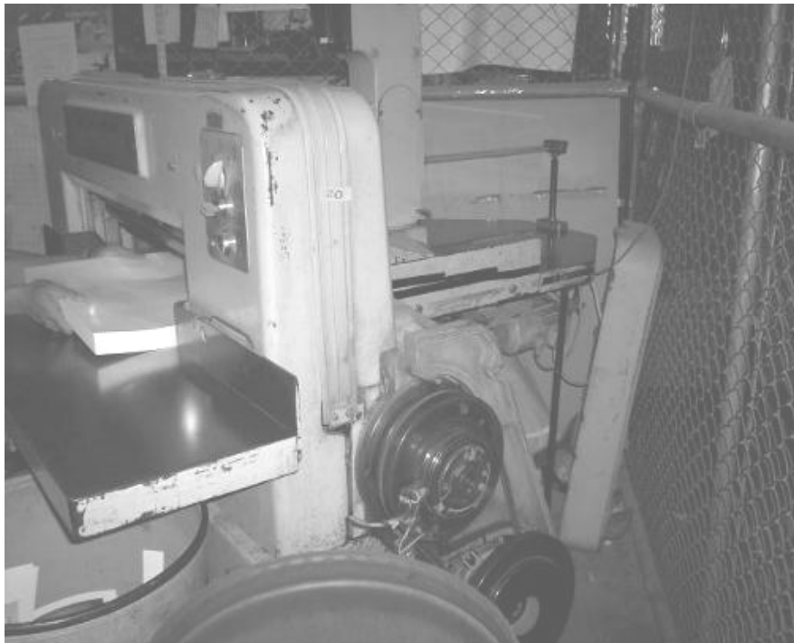
Figura 33. Máquina sin protección
