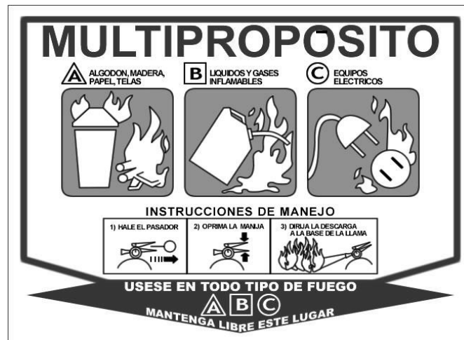
Figura 24. Señalización para informar el correcto uso de los extinguidores de polvo químico seco
