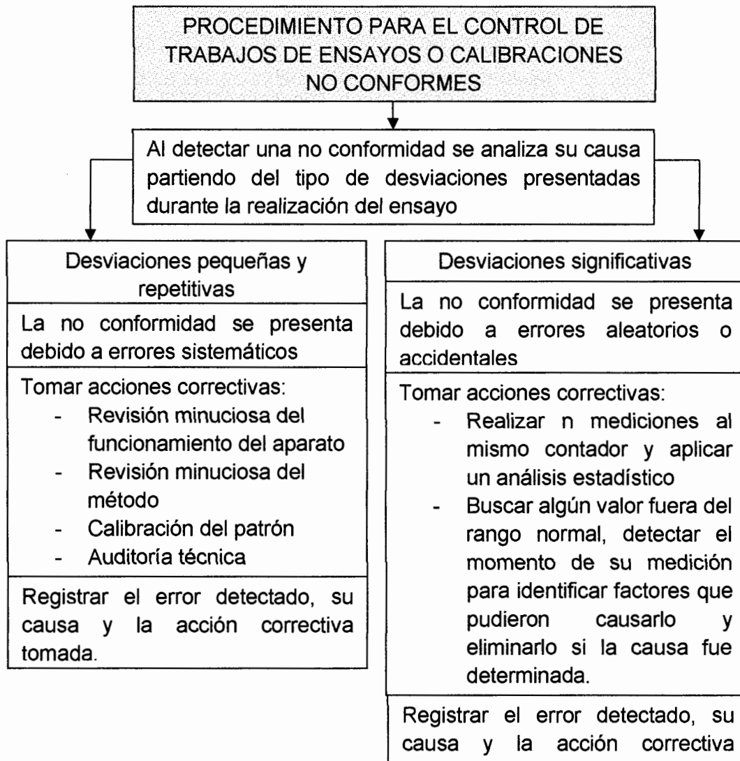
Figura 20. Esquema del procedimiento para el análisis de las causas de resultados de ensayos o calibraciones no conformes
