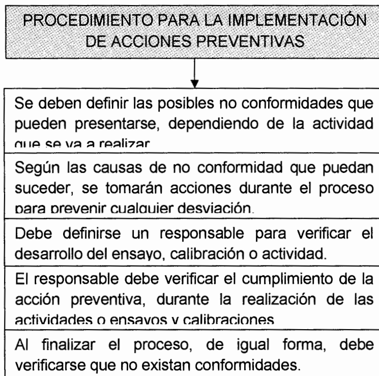
Figura 24. Esquema del procedimiento para la implementación de acciones preventivas
