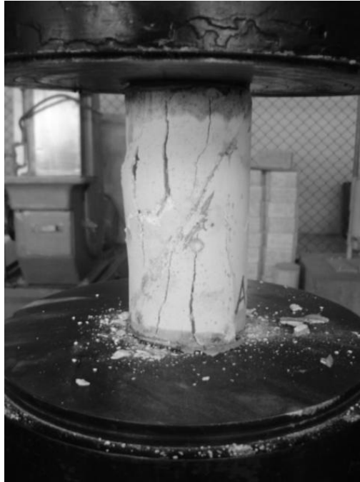
Figura 8. Falla a compresión mortero acabados. Adhesivos Tipo II, A y B
