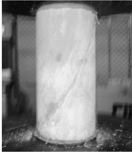
Figura 3. Probeta típica mortero fresco con mortero endurecido
