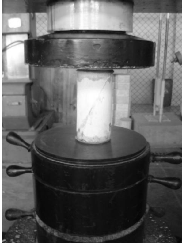
Figura 4. Ensayo típico a compresión
