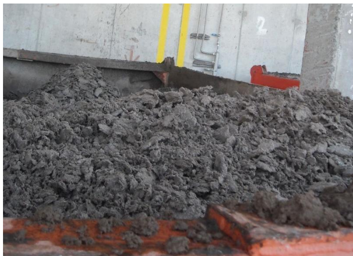
Figura 6. Mezcla de lodo primario y secundario
