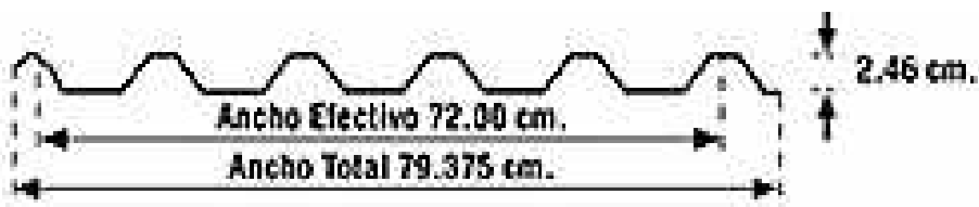
Figura 7. Sección de lámina acanalada ancho corto
