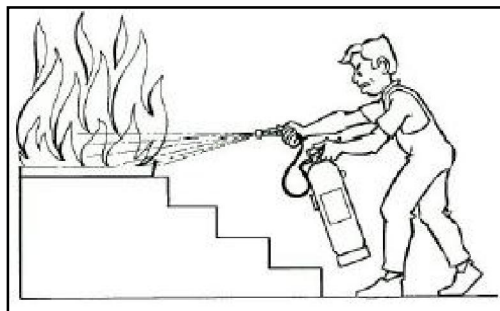
Figura 30. Paso 3 para uso de extintores
