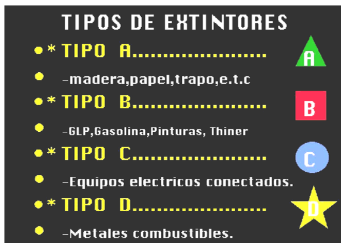
Figura 60. Tipos de extintores
