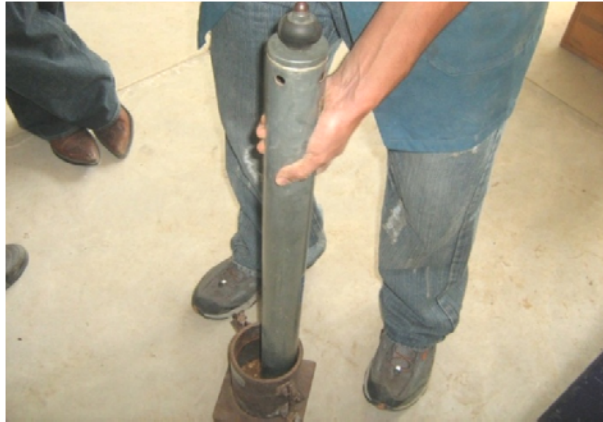
Figura 34. Compactando el material
