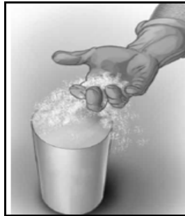
Figura 9. Nivelación del cilindro con azufre
