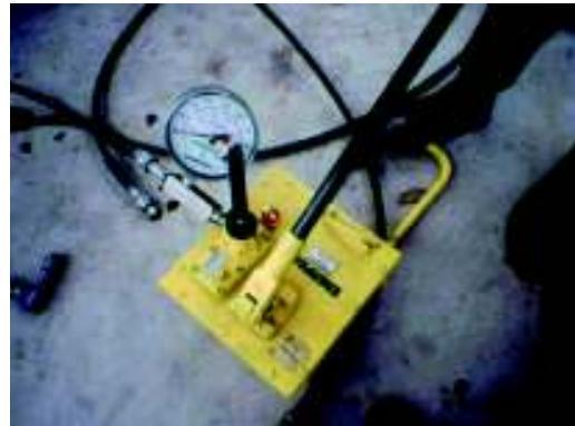
Gato hidráulico aplica carga lateral
