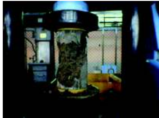
Falla de cilindro a compresión
