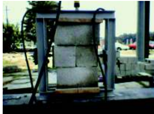
Falla Prisma adherencia y fricción
