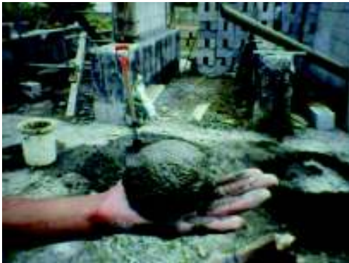
Prueba de la bola de concreto AGIES
