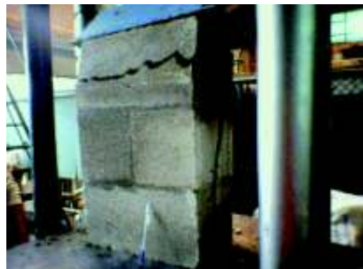
Falla de Prisma a Compresión
