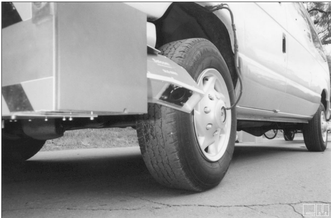
Figura 6. Conexión del medidor de distancia en la rueda delantera
