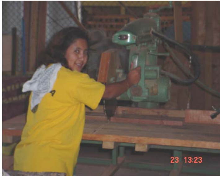
Figura 14. Aserrado de la madera para darle la medida de largo a la pieza de parquet
