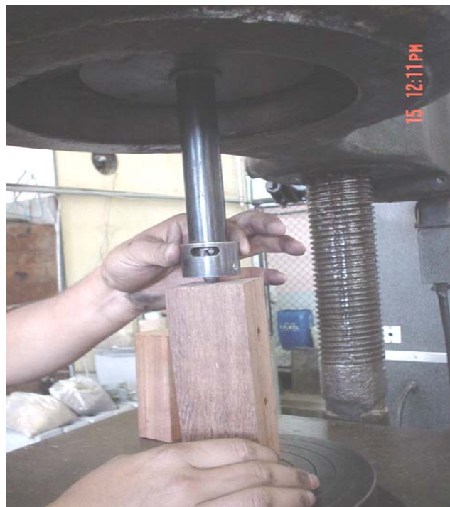
Figura 7. Ensayo de penetración en muestra de Manchiche radial a la fibra de la madera.
