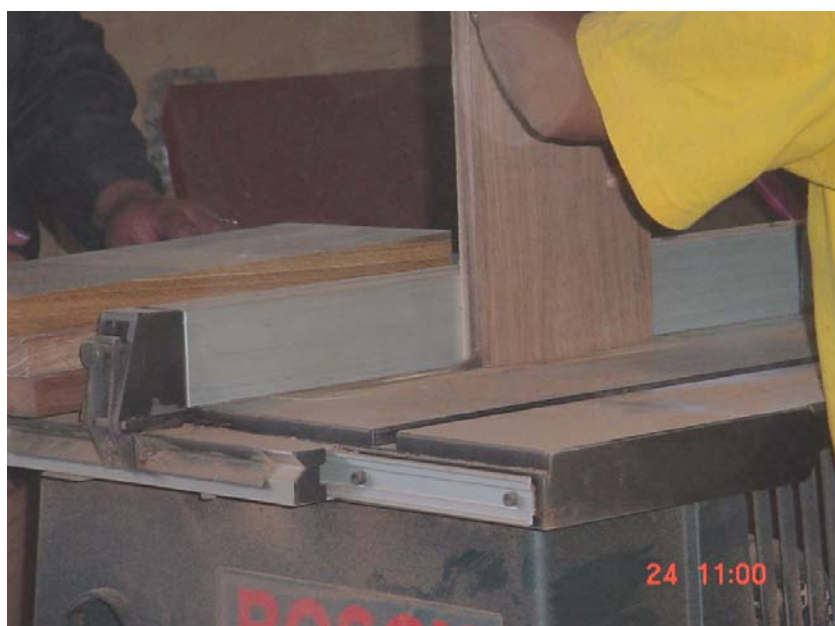
Figura 17. Proceso para el machihembrado del parquet tipo entablonado, realización de la sisa en el lado transversal.
