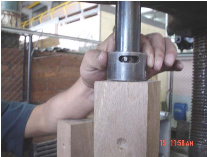
Figura 6. Ensayo de penetración en dirección radial a la fibra en muestra de Pucté
