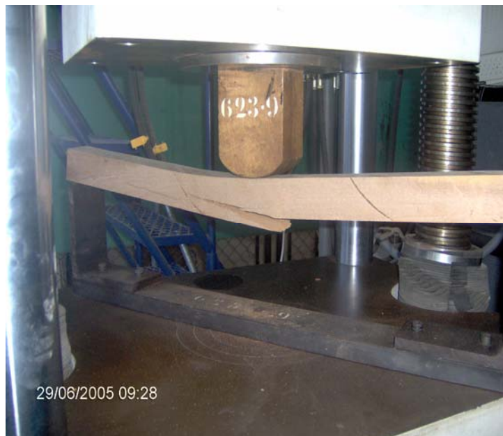
Figura 10. Punto de ruptura del ensayo a flexión de la madera de Pucté
