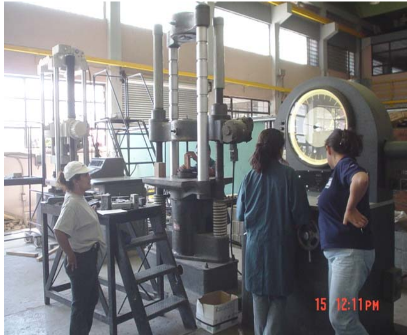
Figura 4. Maquina Universal para ensayo de Dureza
