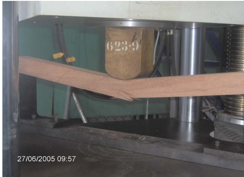
Figura 9. Punto de ruptura del ensayo a flexión de la madera de manchiche
