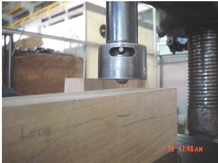
Figura 5. Ensayo de penetración para muestra de Pucté
