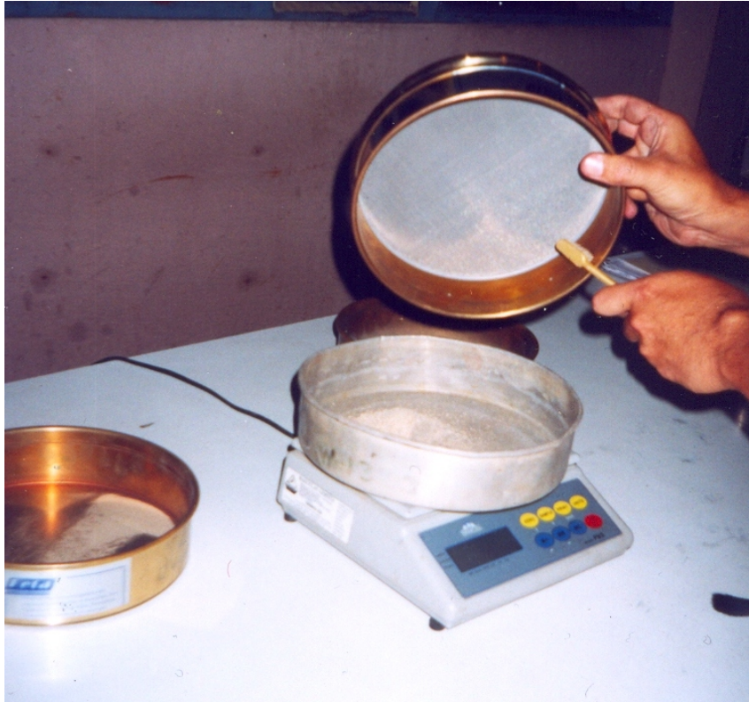
Figura 17. Análisis Granulométrico método mecánico separación del material por tamaño de partícula
