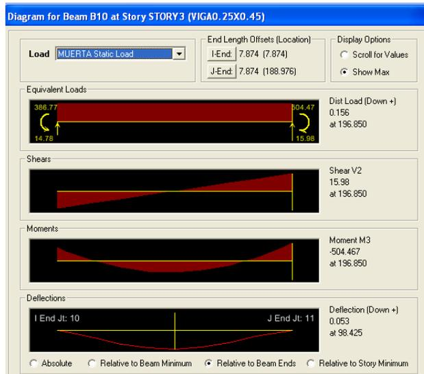
Note que la carga aplicada, corte, momento y deflexión son mostradas para la viga, y los máximos valores son identificados en el cuadro Diagram for Beam Uniform Load mostrada para la viga es la carga tributaria de la losa mas el peso propio de la viga. Las cargas tributarias concentradas no son mostradas.
