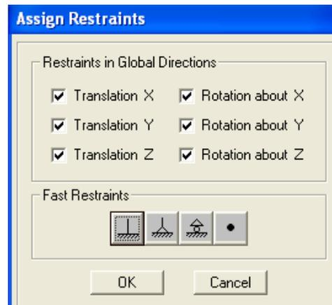
Se seleccionan todas las casillas del cuadro de la figura 101 para seleccionar empotramiento en las columnas y se da *OK*.
