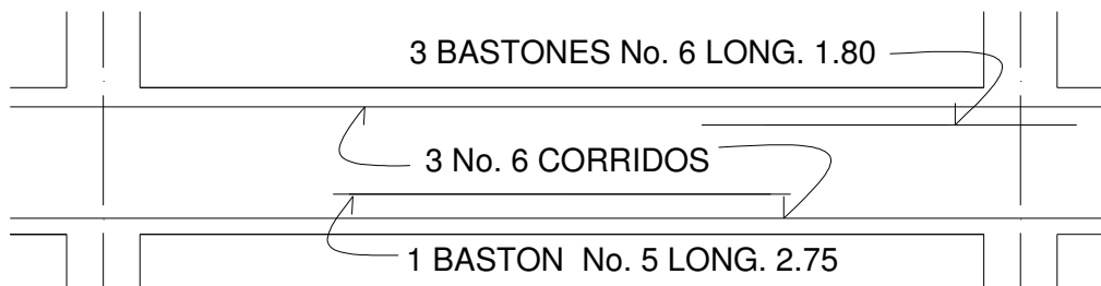
Figura 26. Armado en viga
