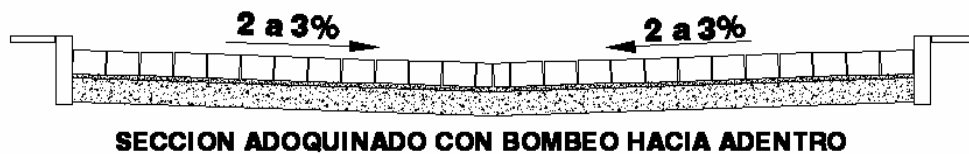
Figura 7 sección transversal de un adoquinamiento típico y sus partes
