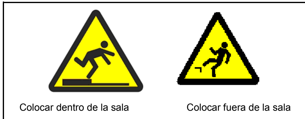
Figura 18. Señalización de advertencia por desnivel
