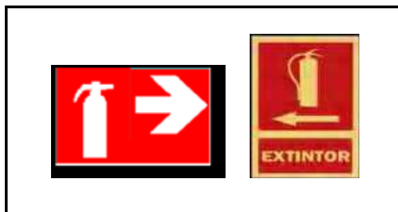
Figura 28. Señalización de ubicación de extintores
