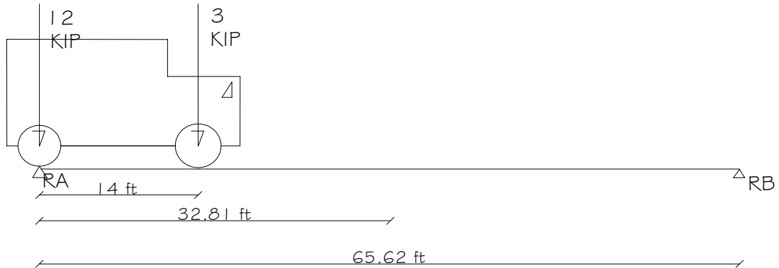
Figura 8. diagrama cuerpo libre carga viva para corte en la viga
