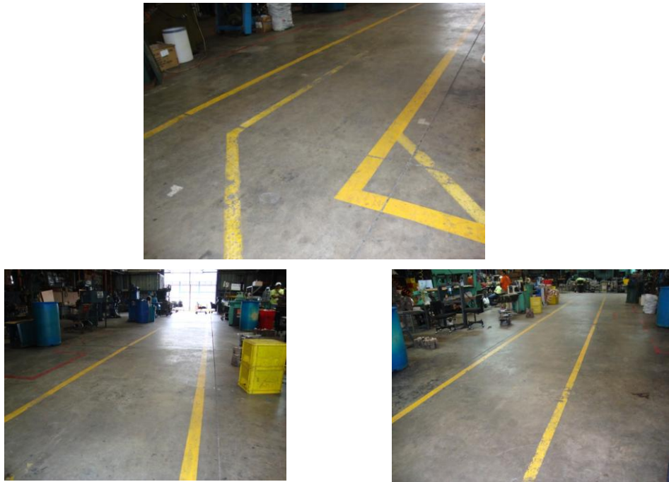
Figura 59. Señalización de ruta de evacuación
