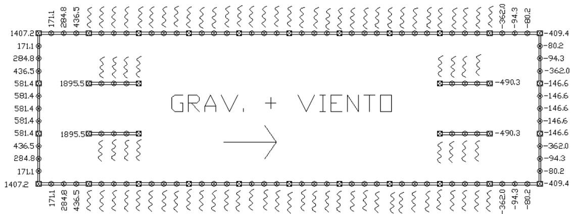
Figura 73. Cargas verticales gravitacionales + viento, Oeste a Este.
