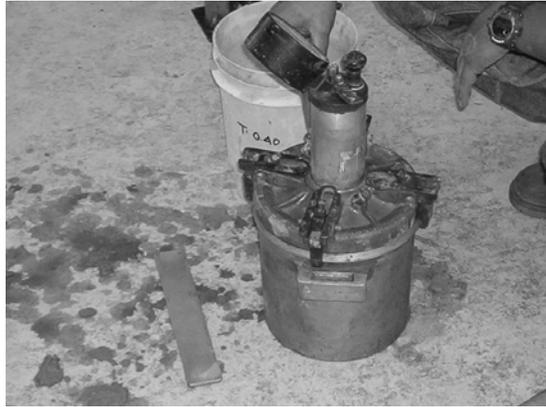
**Figura 8. Medición de % de aire**
