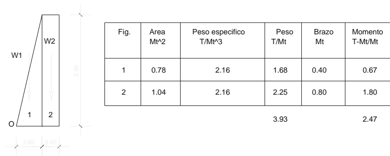
Figura 8. División geométrica del tanque de distribución
