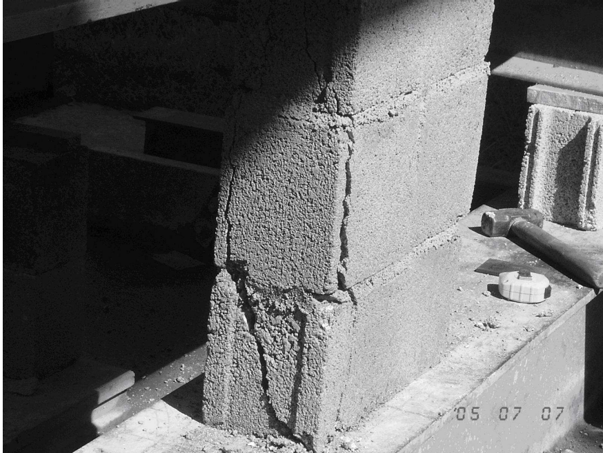
Figura 6. Falla prisma a compresión
