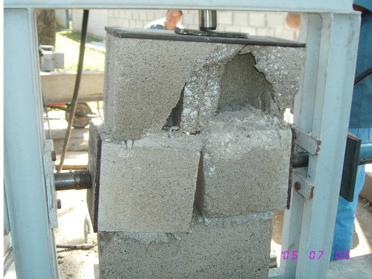
Figura 8. Falla prisma adherencia y fricción
