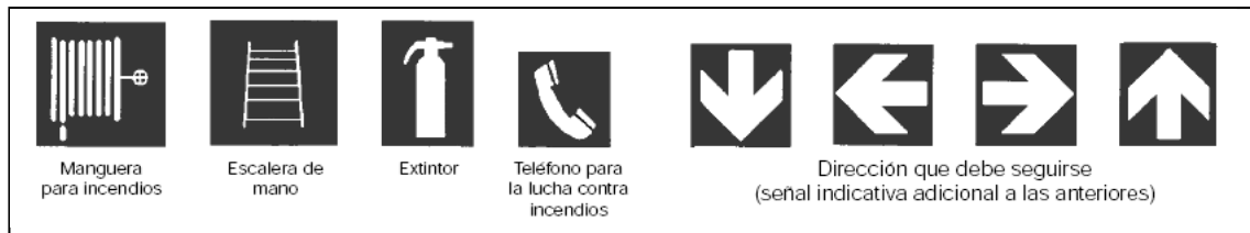
Figura 54. Señales contra incendios
