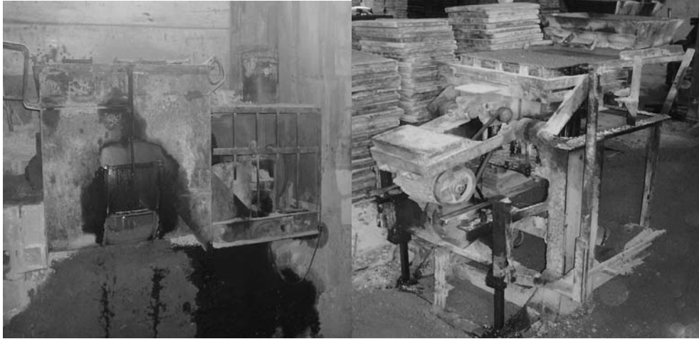
Figura 2. Mezcladora y máquina para fabricar bloque
