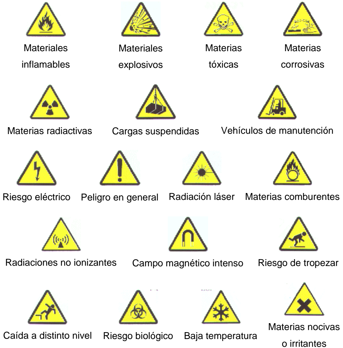
Figura 33. Señales de advertencia
