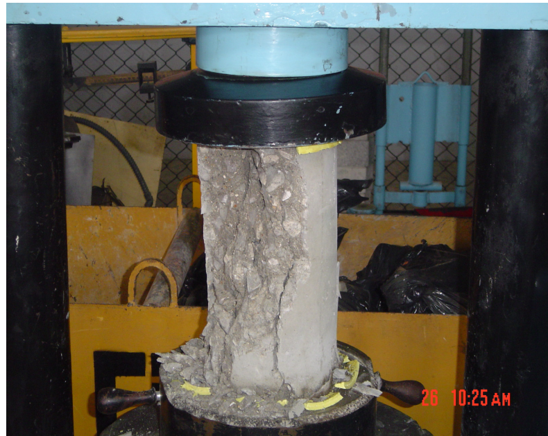
Figura 12. Control de calidad del concreto endurecido en ensayo a compresión. (Tipo de falla: Cónica)
