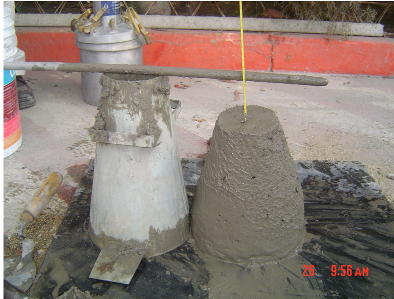
Figura 3. Control de calidad del concreto fresco en medición del asentamiento.
