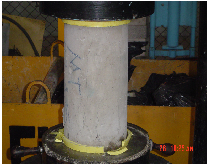
Figura 11. Control de calidad del concreto endurecido en una probeta típica de ensayo a compresión.
