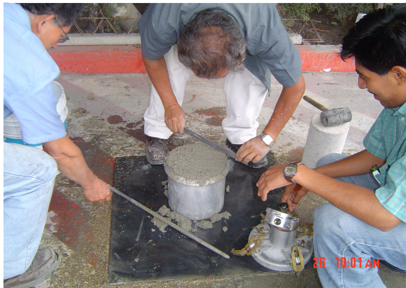
Figura 4. Control de calidad del concreto fresco en contenido de aire.
